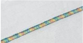
3-Fils flatlock A utiliser afin de mettre un accent sur un endroit particulier de vos vêtements, articles et accessoires.
