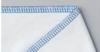
Surfilage 4 fils Utilisez 2 aiguilles et 4 fils pour coudre ensemble les matières extensibles.
