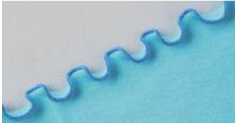
3-fils roulotté avec ajustement différentiel Utilisez ce type de roulotté en vous servant du différentiel sur des tissus stretches afin de créer des articles design.
