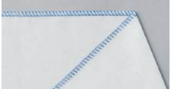
Surfilage 2 fils Surjet simple des bords pour éviter l'effilochage.
